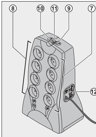
► **Opladen batterij:** de batterij wordt opgeladen zodra de **UPS** op de netspanning wordt aangesloten, en dit ongeacht de stand van de knop ⑪. Bij het eerste gebruik levert de batterij pas de nominale autonomie na 8 uur opladen. Voor een optimale autonomie wordt aangeraden om de **UPS** continu op de netspanning aangesloten te laten.
