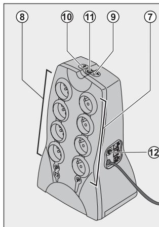
► Ładowanie akumulatora : zasilacz ładuje akumulator od momentu podłączenia do sieci bez względu na stan przycisku ⑪. Przy pierwszym użyciu, akumulator osiąga pełną wydajność dopiero po ładowaniu przez 8 godzin. Aby zachować najwyższą autonomię pracy, zaleca się podłączenie zasilacza na stałe do sieci.
