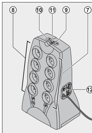
► Par souci d'économie d'énergie, le bouton (11) peut être utilisé pour couper l'alimentation électrique des appareils raccordés sur les prises secourues.
